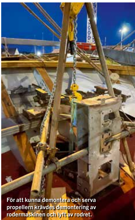
Rodret lyft och fört åt sidan. Här syns även ett rötskadat område i "valvet", när bilden togs är området urhugget och förberett för en ilusning.
