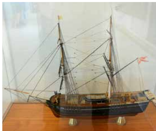
På Aalborgs Sjöfarts- och Marinemuseum visar modellen av Hvalfisken en senare rigg, med delade märssegel.
