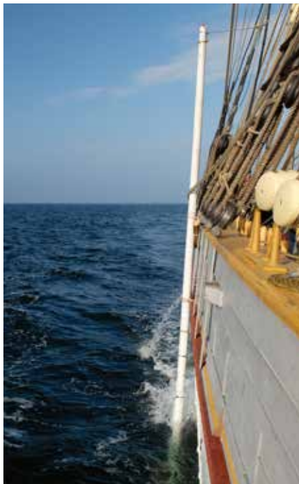
Fältmässig mätning med instrumentet på relingen och spirbommen satt vertikalt med givaren nederst.
