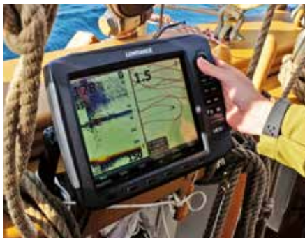
Fältmässig mätning med instrumentet på relingen och spirbommen satt vertikalt med givaren nederst.
