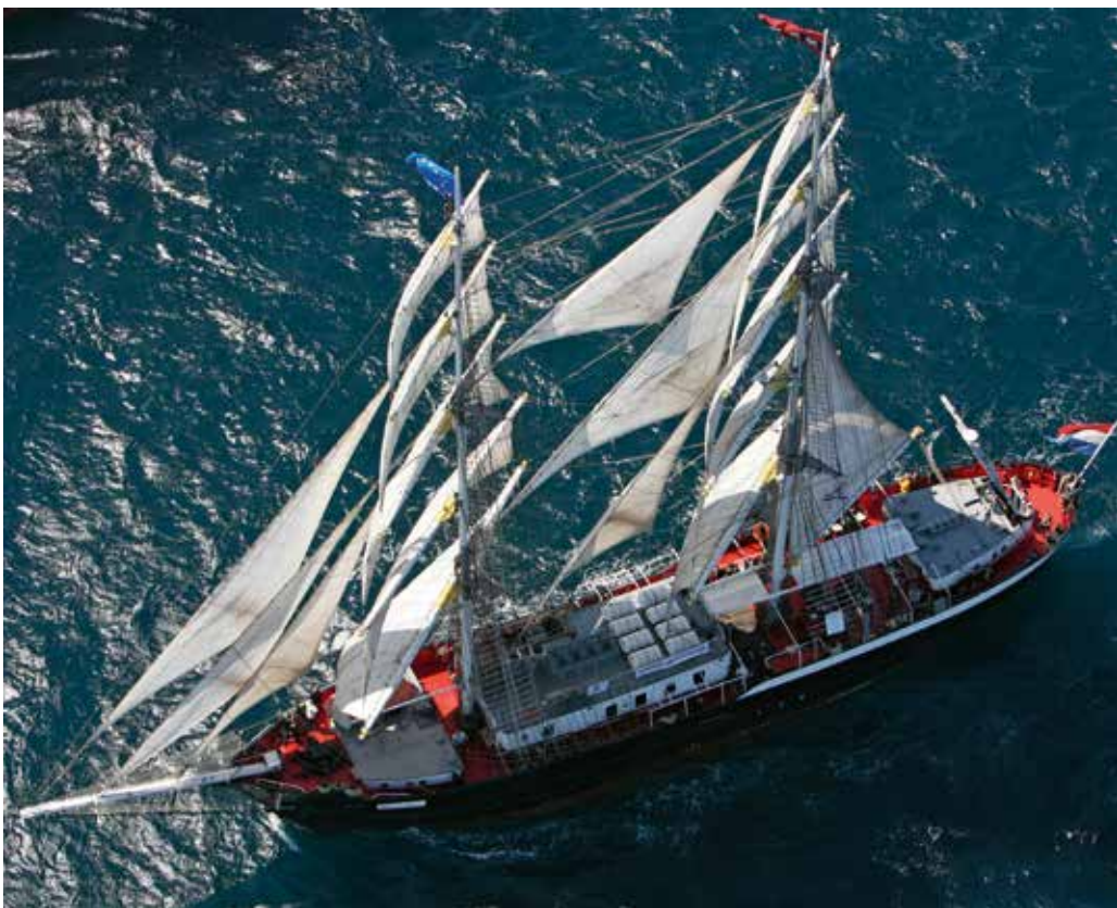
Fasta rår och briggsegel utan gaffel håller nere storleken på den seglande besättningen.
