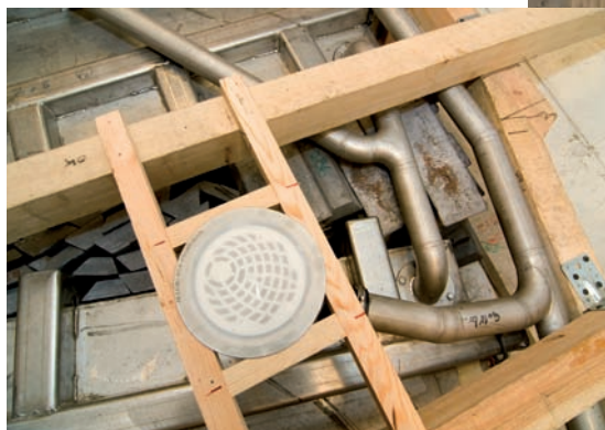
De eleganta rörböjarna för närmast tankarna till ett komplicerat avgassystem på en motorcykel.
