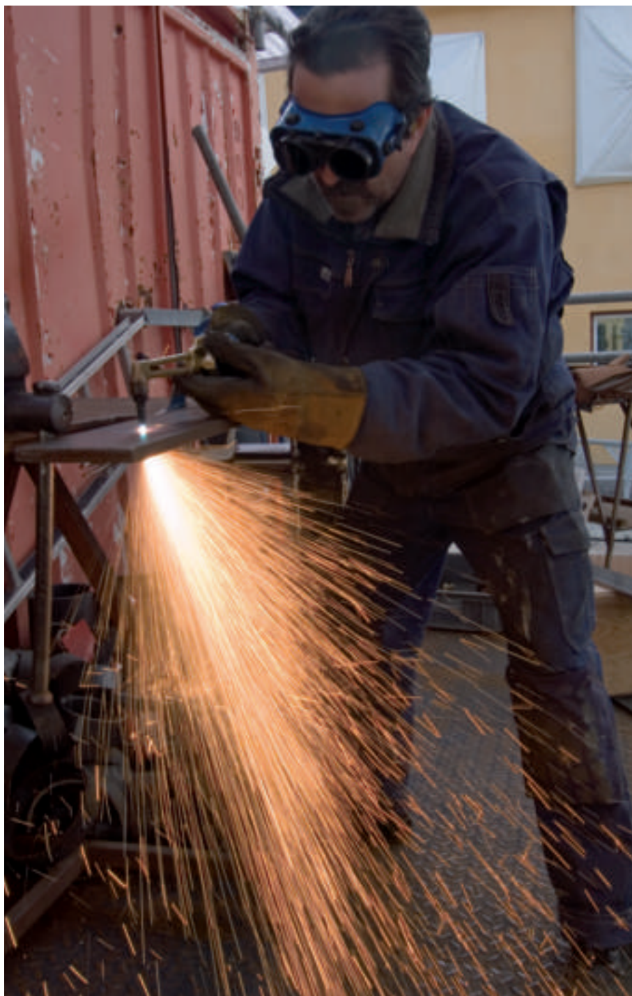
Tomas Hermin gasskär formen på ändarna till roderbeslaget.
