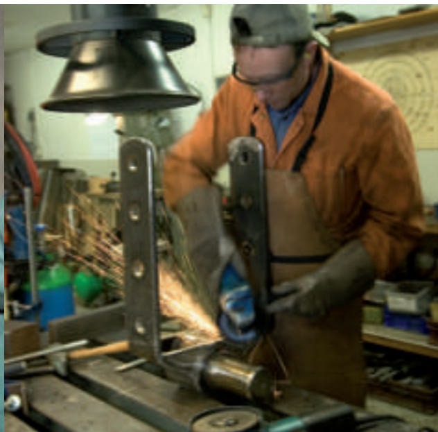
Christer Jonsson slipar en av tre fingerlingar – rodergångjärn. Lägg märke till dimensionen på axeltappen på fingerlingen (lilla bilden i mitten).
