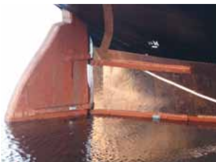
Eric Nordevall II har till skillnad från Tre Kronor af Stockholm kopparförbydring (påspikade kopparplåtar för skydd mot beväxning under vattnet).
